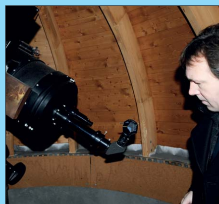
Die Kapsel mit dem Kristall wird auf dem Okular des Teleskops befestigt
